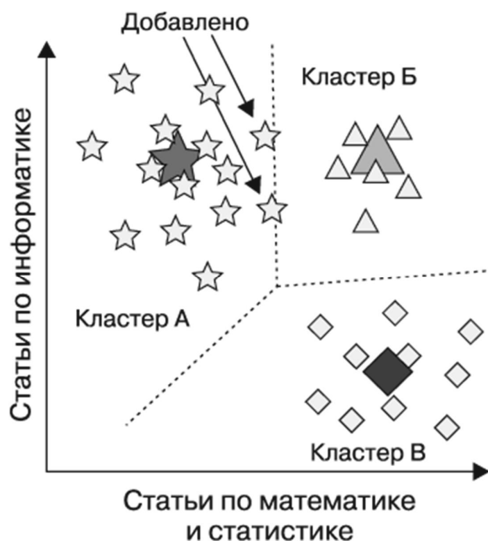
Рис. 9.7. Алгоритм кластеризации останавливается после внесения изменений, если это не привело к переносу точек в другие кластеры
